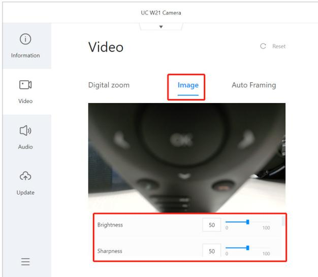
(1) Die Parameter [Brightness], [Sharpness], [Contrast], [Saturation] und [Tone] haben einen Einstellbereich von 0 bis 100. Ihre Standardwerte werden automatisch vom Gerät übernommen. Sie können einen beliebigen Wert zwischen 1 und 100 (einschließlich 1 und 100) eingeben. Wird ein ungültiger Wert eingegeben, erscheint die Meldung "Invalid value".
