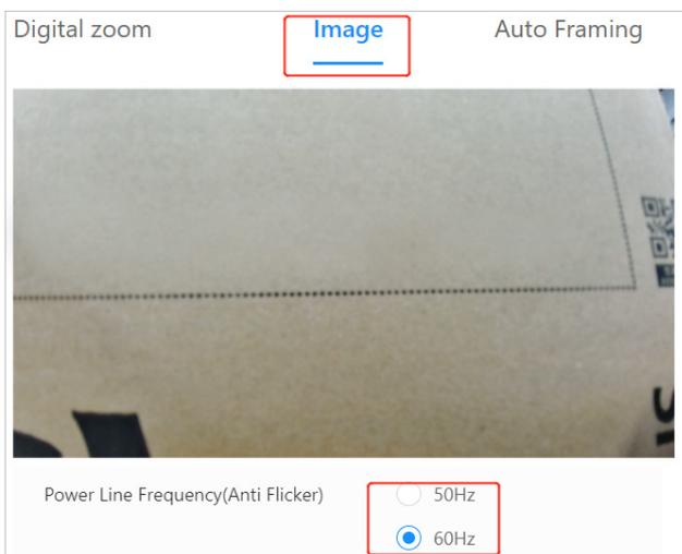
(2) Der voreingestellte [Anti-flashing] Wert wird automatisch vom Gerät gelesen. Es gibt zwei Optionen: 50hz und 60hz.
